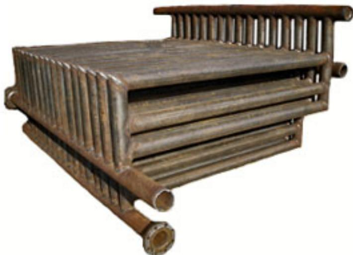
В зависимости от количества секций в блоках котла, можно увеличить теплопроизводительность за счёт величины поверхности нагрева. Стандартные котлы имеют 16 и 18 секций и предназначены для работы на жидком (печном бытовом типа ТПБ) и газообразном видах топлива.
